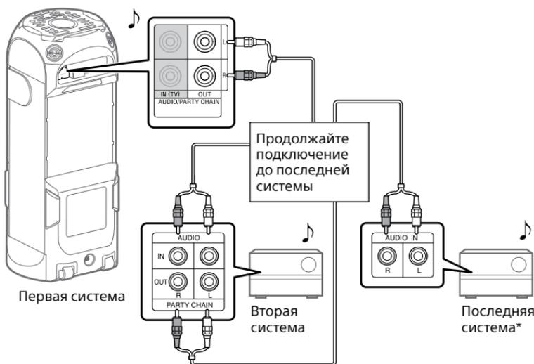
\* Подсоединяйте систему, не оснащенную функцией Wired Party Chain, в качестве последней системы, в противном случае цепочка остановится на этой системе. Обязательно выполните функцию аудиовхода на последней системе.
