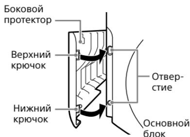
**2** Закрепите боковой протектор на основном блоке с помощью прилагаемого винта.
