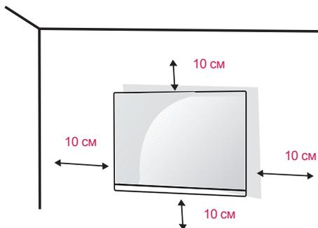
Чтобы установить монитор на стену, прикрепите кронштейн для настенного крепления (дополнительная деталь) к задней части монитора. При установке монитора с помощью крепления для монтажа на стене надежно закрепите крепление, чтобы предотвратить падение монитора.
